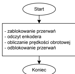
Rys.9. Schemat blokowy programu obsługi przerwania z timera 2
