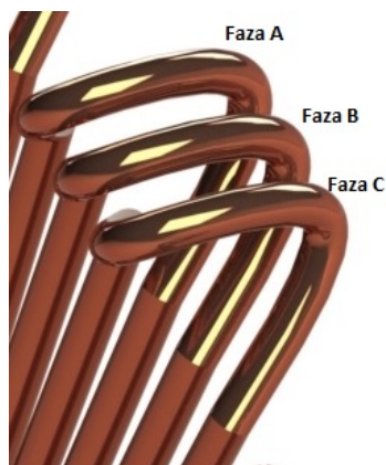
Rys. 13. Fragment połączeń czołowych uzwojenia twornika
