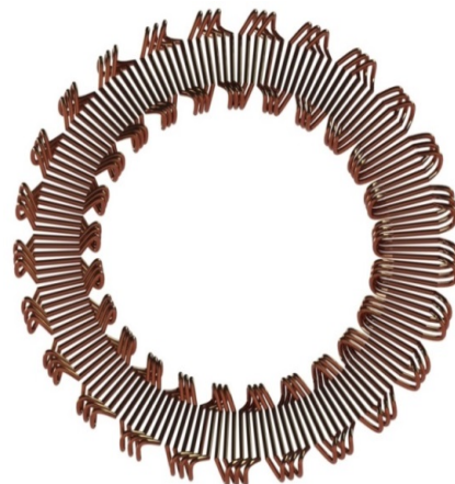
Rys 5. Trójfazowe uzwojenie faliste
