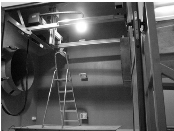
Rys. 4. Manipulator trójosiowy do sond zamontowany w komorze Eiffela
