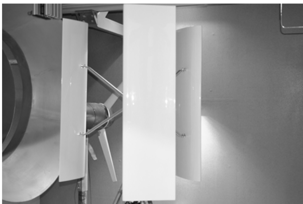
Rys. 8. Badana turbina o osi pionowej w komorze aerodynamicznej
