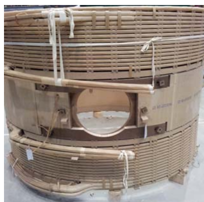
Rys. 6 Uzwojenie REG transformatora 290MVA/400kV nawijane przewodami wg technologii CTC
