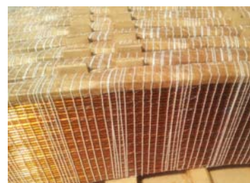
Rys. 8 Uzwojenie nawijane przewodem CTC w oplacie siatkowym
