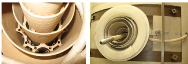
Rys. 9 Modułarny odpyły wysokonapięciowy 400kV wraz z Centralnym Układem Izolacyjnym transformatora 290MVA/400kV
