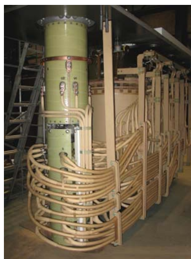
Rys. 7 Część aktywna transformatora TONRLa 32000/15
