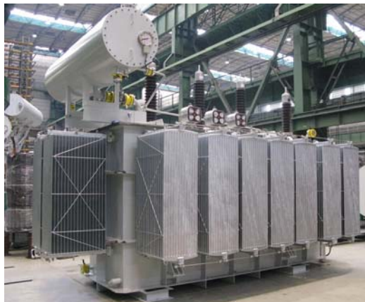
Rys.6 Transformator sieciowy TONRLm 25000/110
