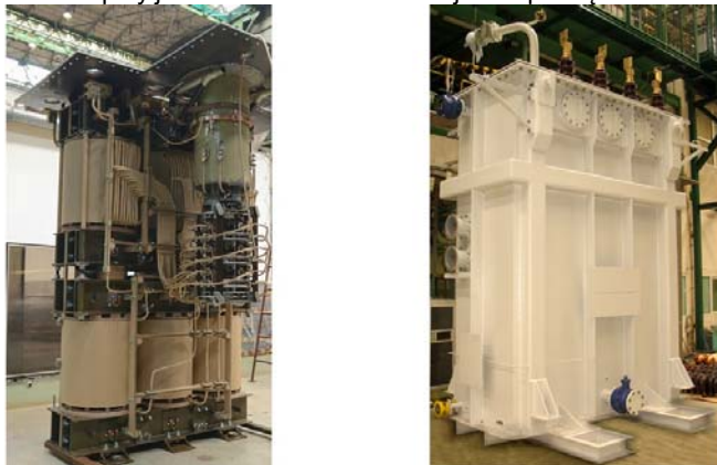
Rys.5 Część aktywna autotransformatora ATOCHL 20 000/6
