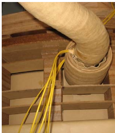
Rys. 8 Wprowadzenia czujników światłowodowych
