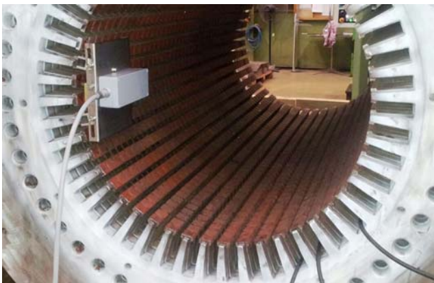
Rys.3 Głowica pomiarowa z uchwytem magnetycznym
