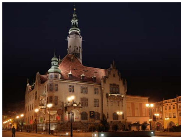
Rys. 5. Wariant 2 – iluminacja dachu ratusza za pomocą naświetlaczy asymetrycznych
