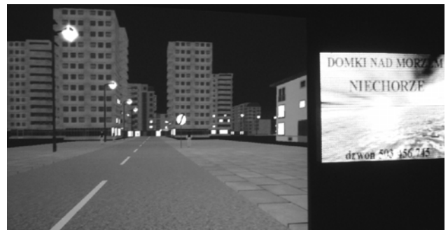
Rys. 10. Wygląd symulatora drogi wraz z usytuowaniem w polu widzenia kierowcy reklamy elektronicznej
