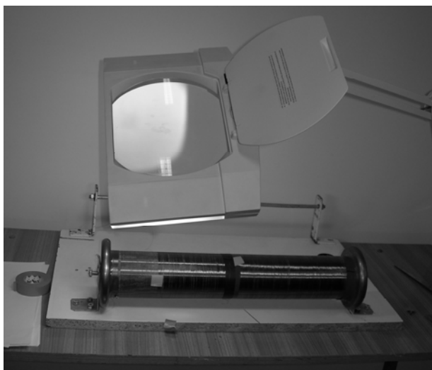
Rys.6. Rezystor wysokonapięciowy dzielnika o oporności 2,5 kΩ, nawinięcie krzyżowe drutu oporowego.
