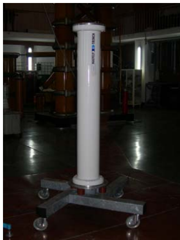
Rys.1. Dzielnik Haefely RCZ500 w hali wysokich napięć Politechniki Wrocławskiej.
