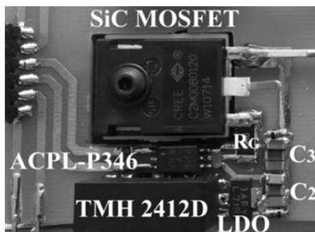
Rys.2. Fotografia wykonanego sterownika bramkowego tranzystora typu SiC MOSFET (Z-FET)
