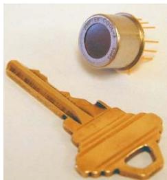
Rys. 2. Źródło COOL-X firmy Amptek wykorzystujące efekt piroelektryczny: a) budowa, b) fotografia [6,7]
