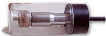
Rys. 4. Lampa rentgenowska 50-kV BS-1 (średnica 40 mm, długość 400 mm) [8]
