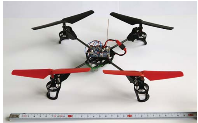
Rys. 1. Miniaturowa platforma latająca użyta do eksperymentów z modułem czujnikowym.
