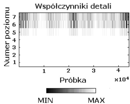
Rys.7. Współczynniki detali dla sygnału akustycznego generatora prądu stałego bez uszkodzeń po filtracji cyfrowej od 223 Hz do 235 Hz
