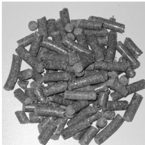
Rys. 1. Wygląd granulatu lignocelulozowego czyli peletu
