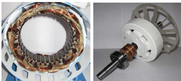
Rys. 2. Widok stojana z uzwojeniem trójfazowym oraz widok wirnika prądnicy z magnesami trwałymi, wykonanego na bazie wirnika kłowego ze wzbudzeniem elektromagnetycznym (opracowanie własne)
