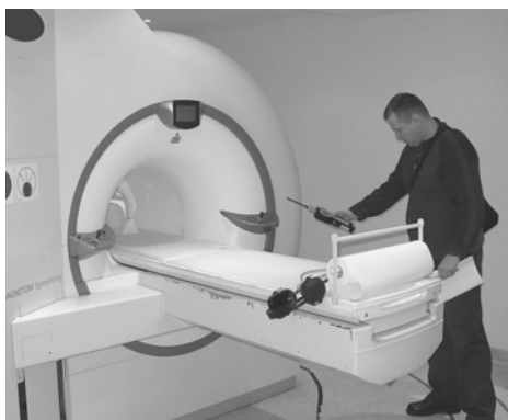
Rys.1. Pomiar natężenia pola magnetycznego dla potrzeb oceny ekspozycji zawodowej
