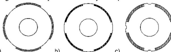
Rys.1. Wirniki wewnętrzne prądnic SPM ( 2p=4 ) z magnesami przyklejonymi na powierzchni wirnika (a) oraz z magnesami trwałymi umieszczonymi w wyciętych „korytkach” (b, c)
