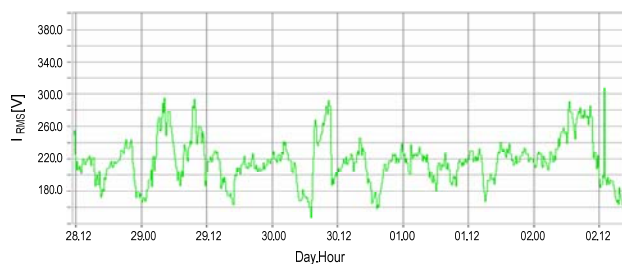
Rys. 6. Wartości skuteczne napięć (a) i prądów (b) strony wtórnej transformatora
