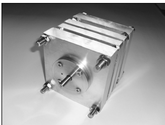
Rys.1. Jeden z wykonanych prototypów bezszczotkowego silnika wysokoobrotowego
