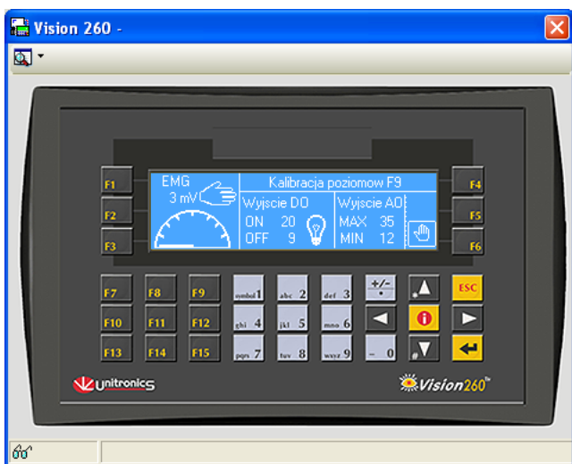
Rys.5 Widok ekranu PLC podczas fazy spoczynkowej mięśnia
