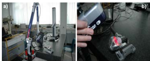
Rys.1. Pomiar głowy kości udowej z wykorzystaniem ramienia Omega 2025 i bezstykowej głowicy skanującej R-Scan RX2
