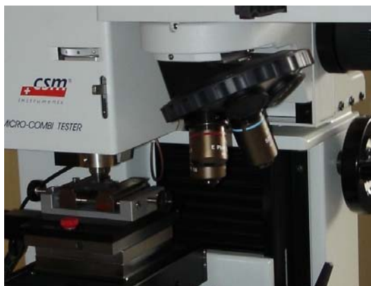
Rys. 3. Urządzenie Micro Combi Tester do badań mikromechanicznych: a) widok urządzenia, b) wgłębnikowanie próbki
