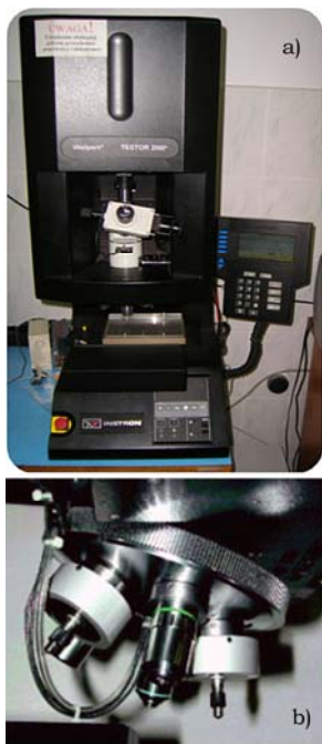
Rys. 2. Urządzenie do badania twardości Instron Wolpert TESTOR 2100: a) widok ogólny, b) penetrator z głowicą badawczą i obiektywem
