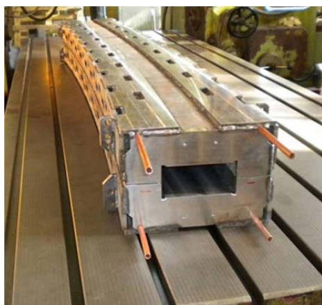
Rys. 1. Elektromagnes nadprzewodnikowy budowany w projekcie Nuklotron-NICA w ZIBJ w Dubnie, Rosja [1-2]
