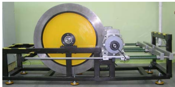
Rys.5. Stanowisko modelowania stanów przejściowych grupowego napędu trakcyjnego
