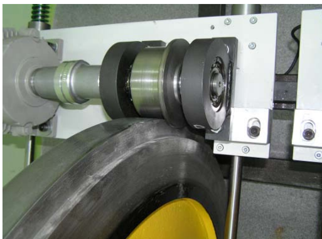
Rys.6. Koło napędowe i koło zamachowe na stanowisku badawczym
