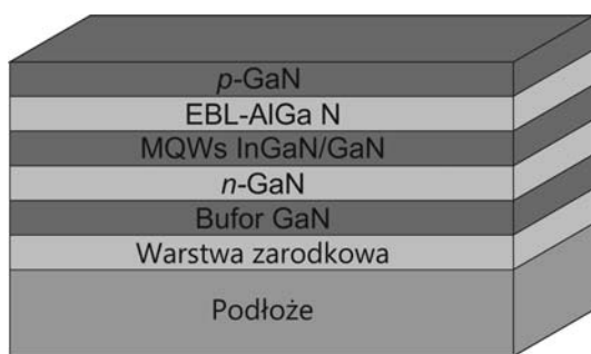
Rys.4. Schemat struktury epitaksjalnej diody elektroluminescencyjnej
