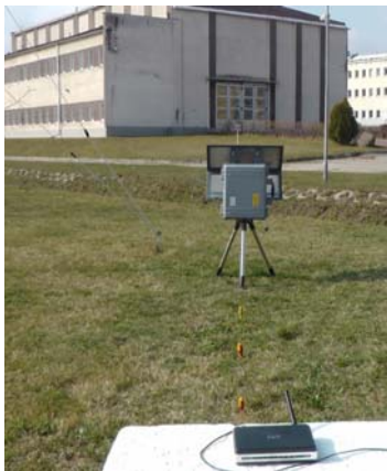
Rys.9. Stanowisko pomiarowe wraz z obiektem badanym (router WiFi standardu 802.11g)
