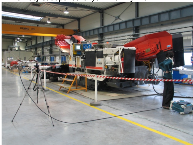
Rys. 1. Przykład pomiaru emisji zaburzeń promieniowanych
