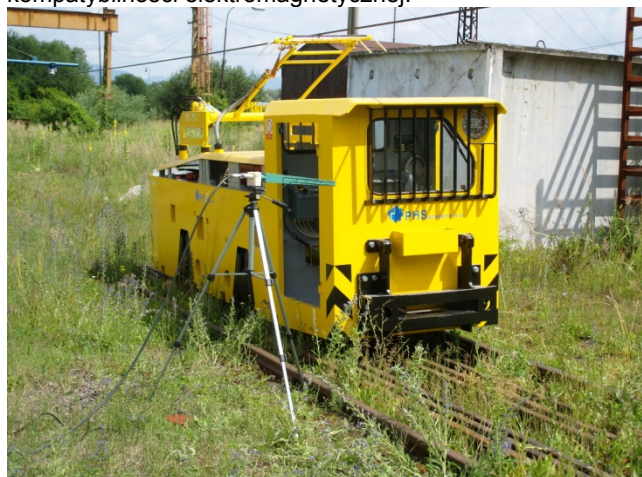
Rys. 5. Przykładowy obiekt podczas badań odporności na zaburzenia promieniowane
