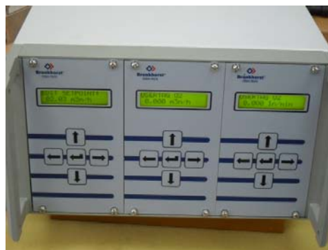
Rys.2. Zestaw regulatorów przepływu Bronkhorst w instalacji reaktora plazmowego
