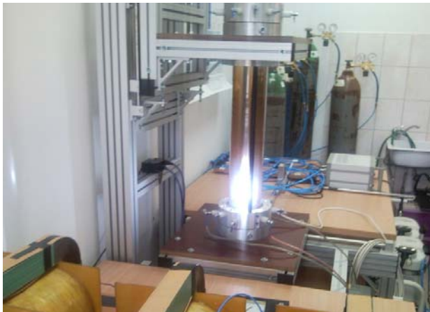
Rys.1. Widok na komorę wyładowczą reaktora plazmowego typu GlidArc, w tle butle z gazami technicznymi, Instytut Podstaw Elektrotechniki i Elektrotechnologii, Politechnika Lubelska
