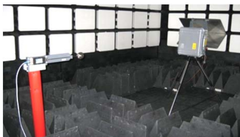
Rys. 5. Widok części stanowiska pomiarowego znajdującego się w komorze bezodbiocowej
