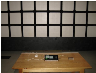
Rys. 1. Widok stanowiska pomiarowego podczas badań w komorze bezodbiwojowej
