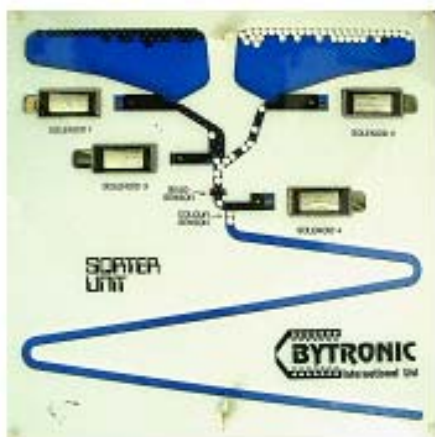
Rys.13. Sortownica – sortowanie błędne (zamknięte zastawki nad zbiornikami)
