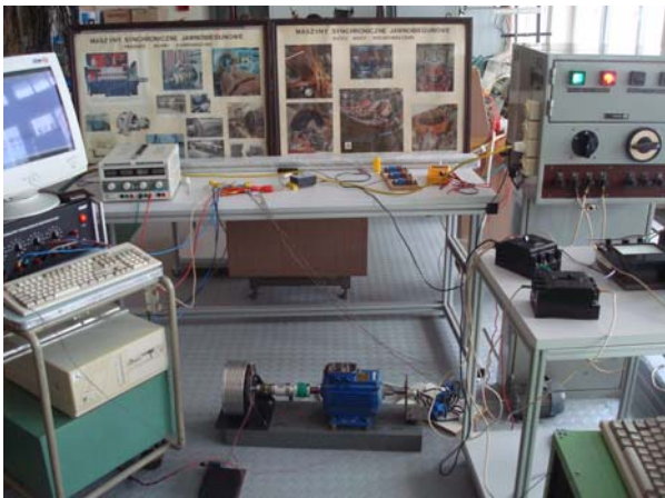
Rys. 2. Silnik z hamulcem histerezyowym w układzie pomiarowym do badania przebiegów podczas zwarcia 2-fazowych
