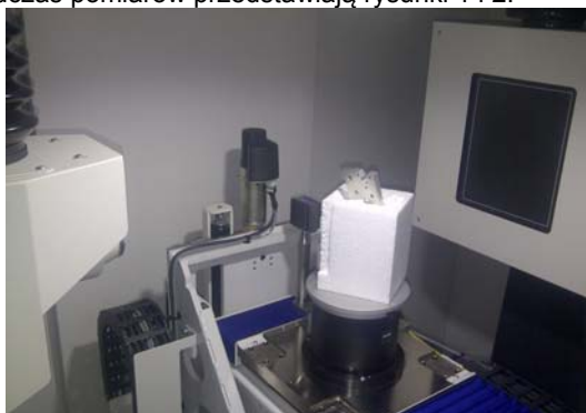
Rys.1. Element pomiarowy wewnątrz komory tomografu METROTOM 800.
