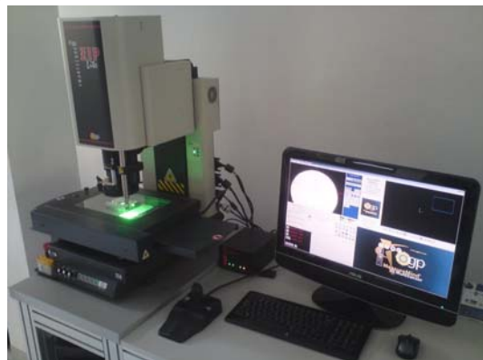
Rys.2. Widok maszyny optycznej OGP podczas wykonywania pomiaru.
