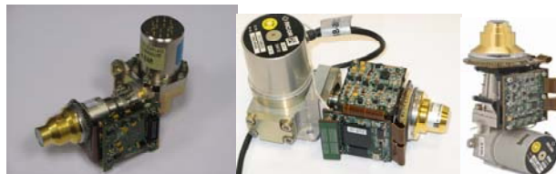
Rys.3. Widok matrycowych detektorów podczerwieni z układami chłodzenia i elektronicznymi zespołami układów odczytu danych. Od lewej: detektor LEO 640x512 ( 15 \mu\text{m} ) firmy SOFRADIR (Francja), detektor PELICAN 640x512 ( 15 \mu\text{m} ) firmy SCD (Izrael) oraz detektor HERCULES 1280x1024 ( 15 \mu\text{m} ) firmy SCD [1]
