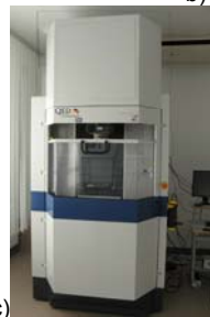
Rys.13. Aparatura DLC (a) do próżniowego nanoszenia warstw typu Hard Carbon oraz aparatura QED (b) do precyzyjnego polerowania elementów optycznych cieczą magnetoreologiczną i interferometr laserowy (c) do pomiaru parametrów wykonanych elementów optycznych (IOE WAT)
