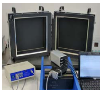
Rys.6. Schemat i zdjęcie stanowiska do wyznaczenia współczynników korekcji NUC oraz do określania uszkodzonych pikseli matrycy detektorów (Instytut Optoelektroniki WAT)
