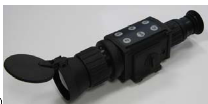
Rys.10. Prototyp obserwacyjnej kamery termowizyjnej (a) z matrycowym detektorem EPSILON firmy SOFRADIR (projekt rozwojowy O R00 0026 08, produkcja PCO S.A.) zamontowanej w zestawie przeciwlotniczym POPRAD (b) oraz termiczny obraz (c) samolotu ORLIK (odległość 2,5 km) [5]
