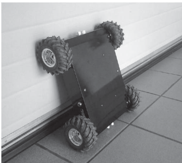
Rys. 24. Próba wykonania obrotu z wykorzystaniem pionowej powierzchni
