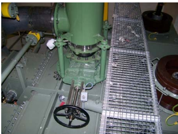
Foto. 5. Zestaw rozprężający SERGI z dyskiem i zaworem rozdzielającym
