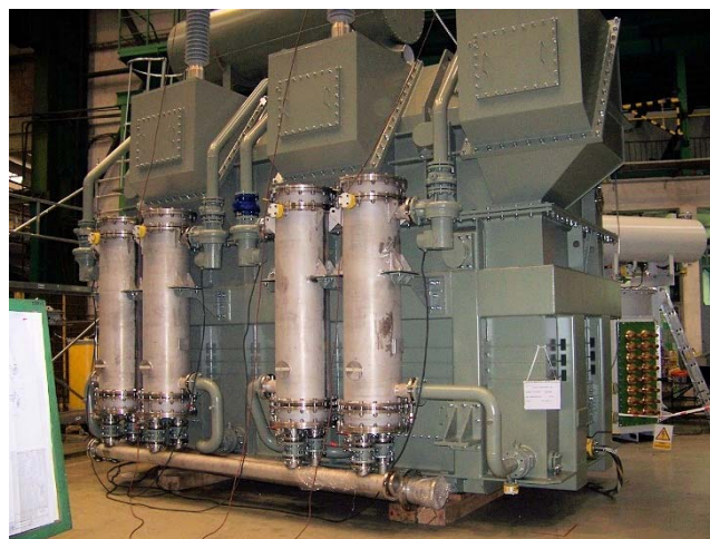
Foto. 2. Nowy transformator blokowy
