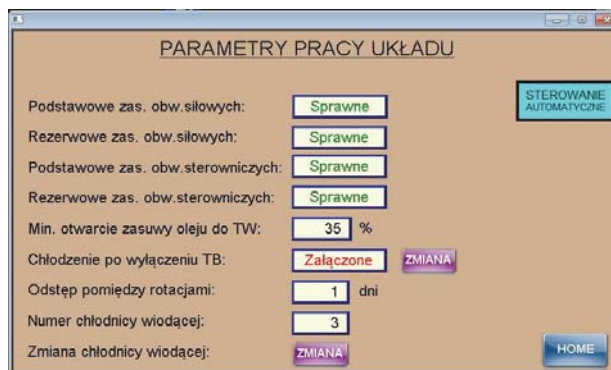
Rys. 4 Ekran synoptyczny pokazujący status pracy układu chłodzenia
