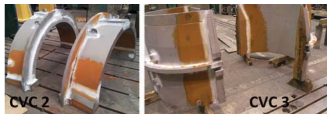
Rys.6 Kierownice łopatek CVC2 oraz CVC3 po badaniach UT
