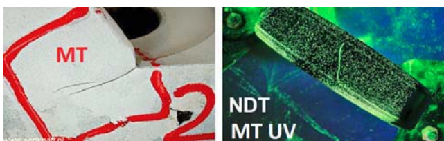
Rys.5 Obraz wady spawalniczej uzyskany w badaniu MT z wykorzystaniem proszku magnetycznego oraz MT w świetle UV z wykorzystaniem zawiesziny fluorescencyjnej [8], [11].
