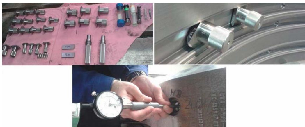
Rys.10 Sprawdziany Go/No-Go (przechodnie i nieprzechodnie) oraz przykład pomiaru czujnikiem zegarowym.
