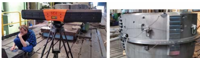
Rys. 13 Pomiar kontrolny CVC3 z wykorzystaniem przenośnego trakera optycznego firmy NDI.
