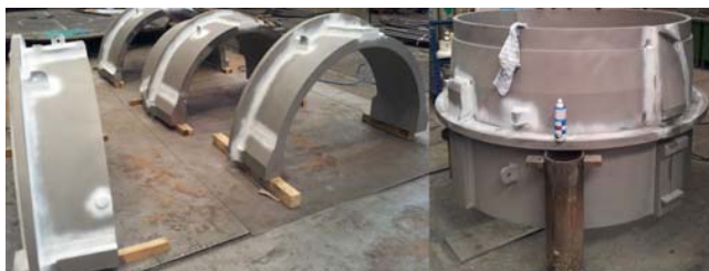
Rys.4 Kierownice łopatek CVC2 i CVC3 w trakcie badania MT.
