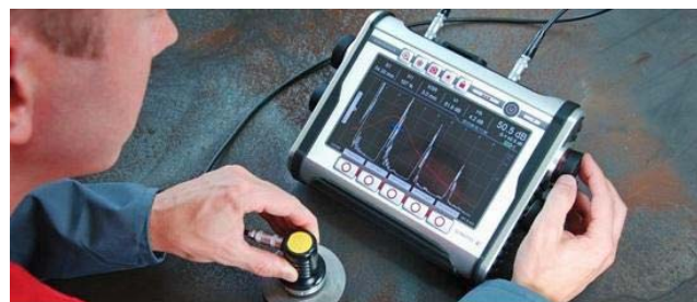
Rys.7 Przykładowy obraz uzyskiwany na defektoskopie w trakcie badania UT [12].
