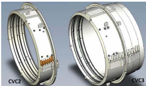
Rys.2 Wizualizacja kierownic łopatek stacjonarnych.
