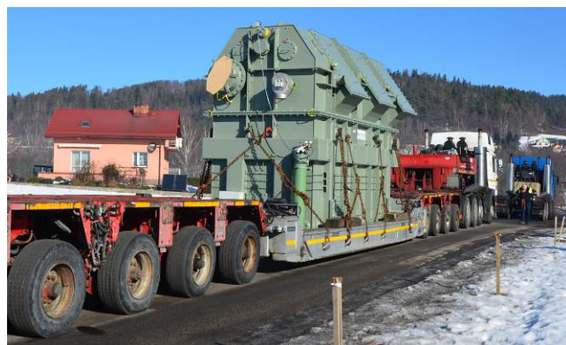
Rys.5. Transport drogowy transformatora 156MVA
