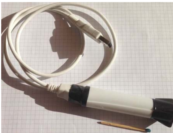
Rys.23. Prototypowy tester (sonda detekcyjna) eksploatacyjnej degradacji zmęczeniowej materiału
