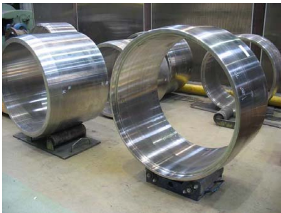
Rys.2. Widok kołpaków zdemontowanych z wirników, na stanowisku do badań nieniszczących
