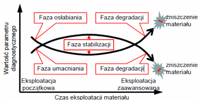
Rys.5. Przykładowe przebiegi zmian wartości parametrów fizycznych powodowanych eksploatacyjnym zużyciem się materiału
