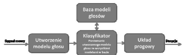
Rys. 1. Schemat identyfikacji głosowej w otwartym zbiorze mówców.
