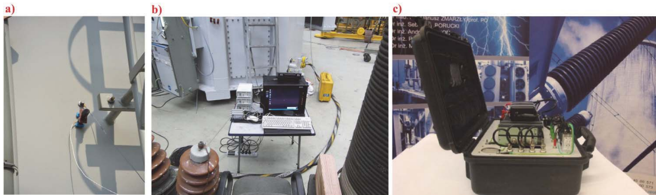
Rys. 2. Widok ogólny układu pomiarowego: a) przetworniki pomiarowe, b) układ akwizycji danych, c) system Pulse DYN-XI
