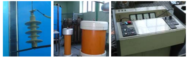
Rys. 5. Izolator w komorze deszczowej podczas próby napięciowej i użyte wysokonapięciowe stanowisko probiercze wraz z pulpitem sterowniczym [opr. własne]
