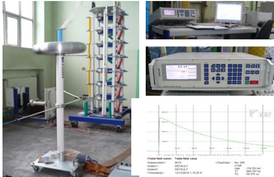
Rys. 3. Stanowisko do wysokonapięciowych prób napięciami udarowymi firmy Haefely [opr. własne]
