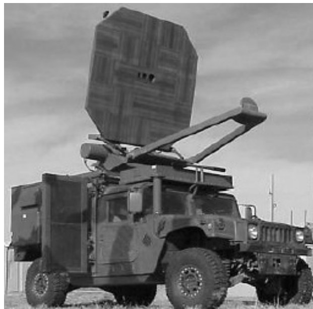
Rys.1. Przewoźny generator promieniowania na samochodzie typu Humvee – amerykańska broń mikrofalowa Active Denial System ADS (źródło: Wikimedia Commons)
