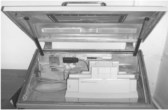
Rys.4. Przykład obudowy ekranującej chroniącej znajdujące się w niej urządzenie przed oddziaływaniem zewnętrznego pola elektromagnetycznego oraz przed wypromieniowywaniem znacznej energii elektromagnetycznej w otaczającą przestrzeń (podczas pracy pokrywa jest oczywiście zamknięta)
