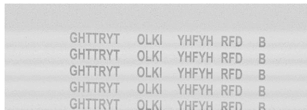
Rys.4. Fragment przykładowego obrazu odtworzonego z sygnału emisji ujawniającej ( f_{od} = 230 MHz) typowej drukarki laserowej (inwersja obrazu, rozmiar znaków: 28 pkt)
