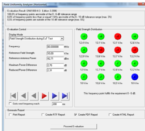
Rys. 3. Oprogramowanie EMC32 – panel modułu analizatora jednorodności pola
