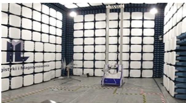
Rys. 1. Komora bezodbiciowa SAC-3 w ILiM
