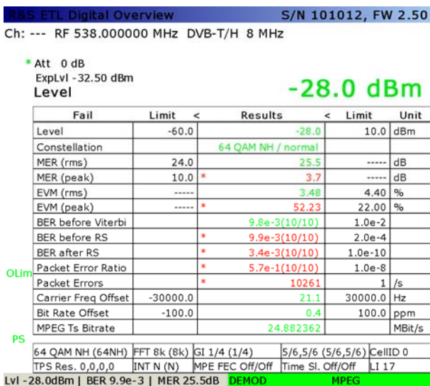
Rys.1. Przykład reakcji odbiornika testowego DVB-T na produkty intermodulacji z udziałem sygnału od WSD, kolorem czerwonym oznaczono przekroczenia zakresów dopuszczalnych niektórych parametrów transmisji w wyniku zakłócenia
