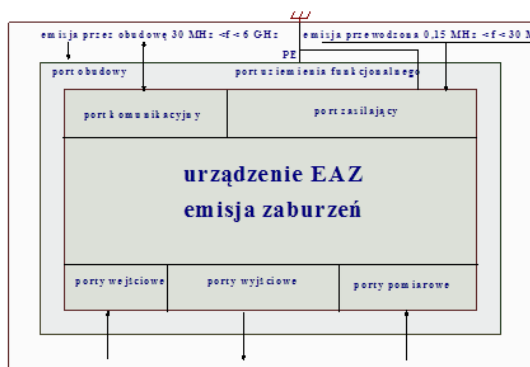
Rys.1. Rodzaj i lokalizacja miejsc emisji zaburzeń przez urządzenia Elektroenergetycznej Automatyki Zabezpieceniowej
