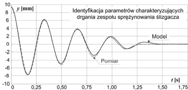
Rys.7. Przykładowy przebieg ruchu elementu odbieraka prądu
