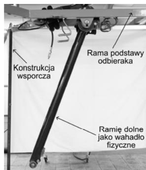
Rys.6. Widok stanowiska laboratoryjnego
