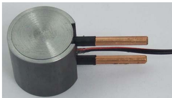
Rys.14. Ekran magnetyczny jednofazowego modułu przekładnika (opracowanie własne) [15]
