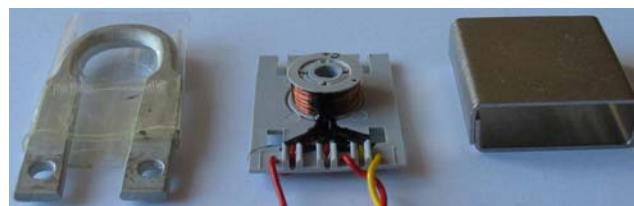
Rys.3. Cewka Rogowskiego, od lewej: tor prądowy, cewka, ekran magnetyczny (fotografia autora)
