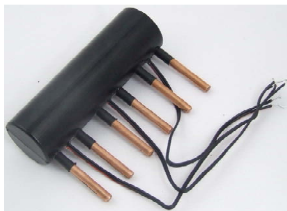
Rys.13. Moduł trójfazowy przekładnika prądowego z umieszczonymi trwale torami wysokoprądowymi (opracowanie własne) [15]
