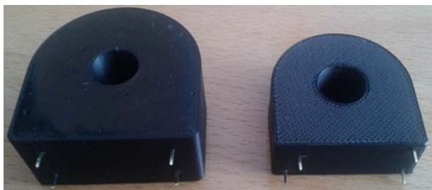
Rys.12. Wyprowadzenie uzwojenia wtórnego z obudów przekładników prądowych za pomocą pinów (opracowanie własne)
