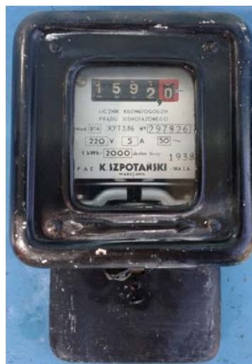
Rys.1. Licznik indukcyjny energii elektrycznej produkcji FAE K. Szpotański, model BT4, rok produkcji 1938 (z kolekcji autora)
